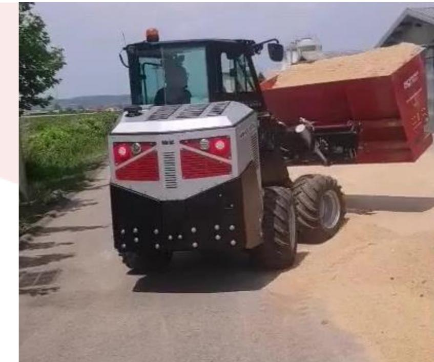
Le quattro ruote motrici e sterzanti **4WS** con la possibilità di blocco del telaio di Mangusta sono il segreto di una manovrabilità assoluta senza termini di paragone nel mercato. La distribuzione articolata e l'ampio angolo di snodatura del corpo offrono all'operatore la scelta di 3 tipi di sterzatura. Un'esclusiva MAAC che assicura un'assoluta precisione di movimento anche in posizioni con poco spazio di manovra.
