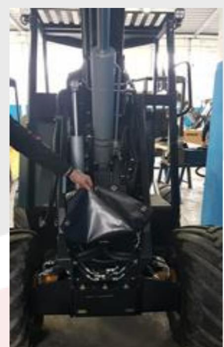
Per una efficace e pratica pulizia, la macchina può essere dotata di un robusto telo di copertura dei tubi idraulici che può essere facilmente rimossa senza attrezzi quando si vuole fare una pulizia accurata all'interno della macchina.
