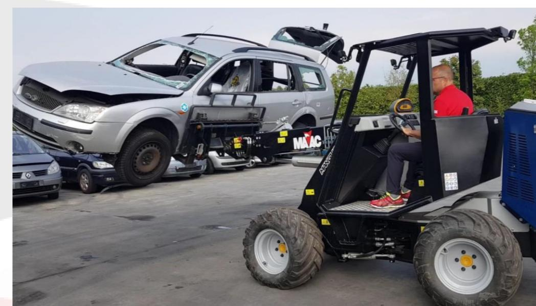
Un braccio telescopico di 4 METRI unito ad un potente impianto idraulico permette di usare l'agilità e la compattezza di MANGUSTA in nuovi settori.
