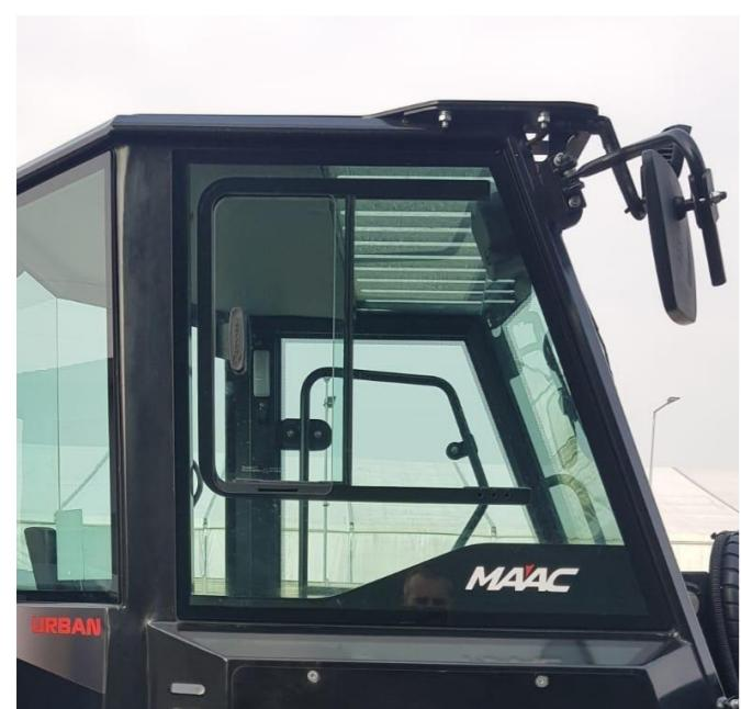
Finestrino laterale scorrevole per limitare l'entrata della polvere e permettere il controllo manuale dello specchietto dall'interno della cabina
