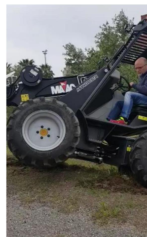
Il sistema di trasmissione idrostatica aziona i motori idraulici posizionati in ogni ruota permettendo una tenuta ottimale per tutte le superfici; la regolazione delle valvole permette una regolazione del flusso idraulico che, agendo come un blocco differenziale migliora la trazione nelle superfici scivolose o irregolari.
