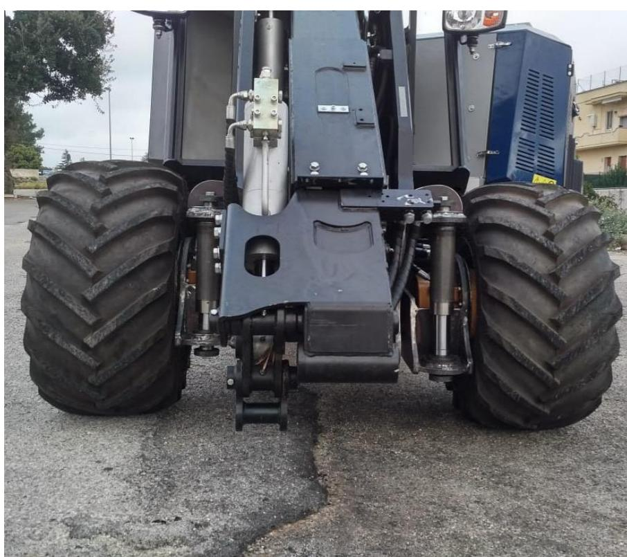
Le geometrie della macchina in particolare il rapporto tra lunghezza/larghezza sono state studiate per dare la massima stabilità alla macchina in ogni condizione, di conseguenza per particolari condizioni è anche possibile variare le geometrie: la larghezza può variare tra da 1400 mm a 1800 mm, la lunghezza da 3500 mm a 3700 mm, Ed infine, unica nel suo genere è possibile montare delle **SOSPENSIONI BASCULANTI** nell'asse anteriore per avere sempre le 4 ruote a terra.
